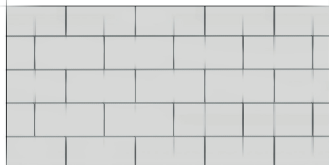
Правильный способ расположения швов между изоляционными плитами
